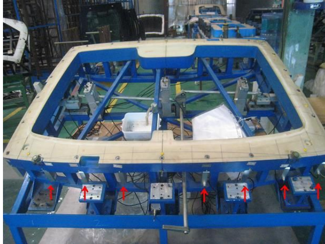
图片为挡风玻璃检具，红色箭头处安装了测微计
