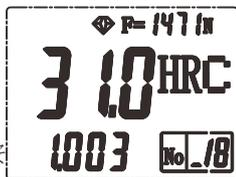
按则连续减小。硬度显示值将随着比例系数的变化。而相应变化。当硬度显示值调整到目标值时,短按【SET】键可以保存修正系数并退出修正状态,回到第4步。如果在此过程中如果撤掉初始力硬度计会退出杠杆修正显示当前测量结果。
